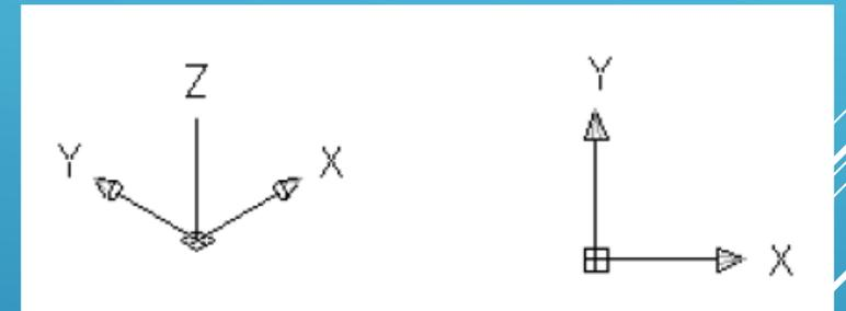
O AutoCAD é um programa que funciona vectorialmente, ou seja, cada ponto na área gráfica corresponde a um vector com a origem em  $X=0$  e  $Y=0$ , com determinado comprimento e um ângulo com relação ao eixo X, apontando para a posição do ponto. A área de trabalho mostra (por default) sempre o primeiro quadrante, ou seja, a parte do plano onde X e Y que são positivos.
